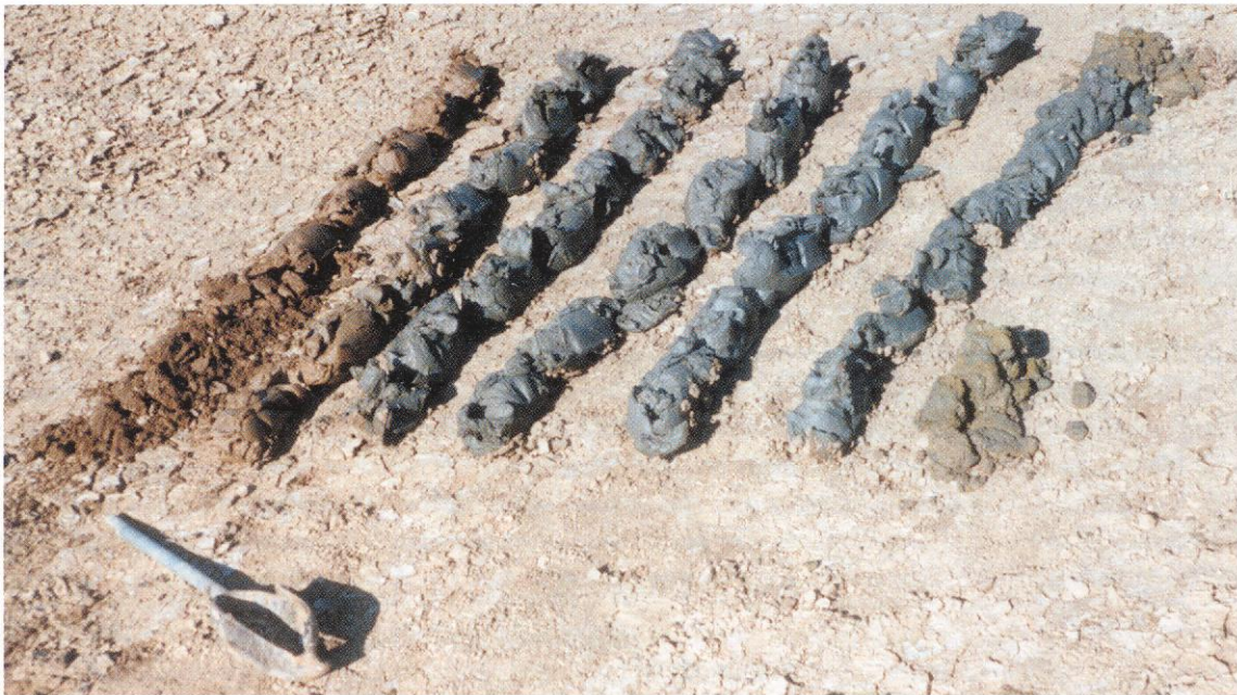
Abb. 2 Ausgelegtes Bohrprofil einer Bohrung, in der eine vollständige Abfolge der holozänen Sedimentation einschließlich des darunter anstehenden Präholozän gefunden wurde. Links liegt der erste Bohrmeter, die weiteren Bohrmeter bis zur Endteufe von 6,2 m folgen jeweils nach rechts. Zum Betrachter zeigt jeweils das obere Ende eines Bohrmeters. Im Vordergrund liegt als Maßstab eine 10 cm Kombi-Bohrkrone.
